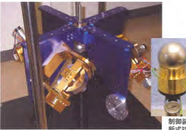
JAXAから依頼された人工衛星姿勢制御試験装置
